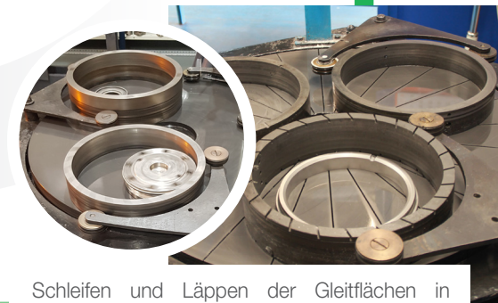
Schleifen und Läppen der Gleitflächen in Materialien wie Siliziumkarbid oder Wolframkarbid und die Herstellung derselben in Materialien wie Graphit, Antimon oder PTFE.
