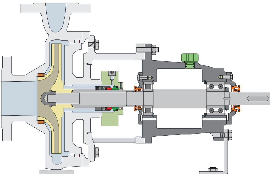
•Tipos y medidas: Las juntas de laberinto se diseñan en función de las características de la aplicación.
