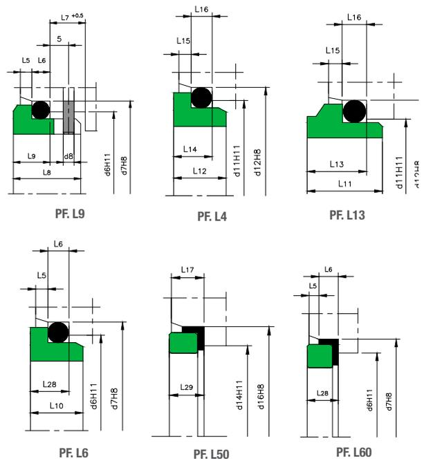
Tolerancias l, d, 10... 12 mm ± 0.5; 14... 18 mm ± 1.0; 20... 25 mm ± 1.5; 28... 100 mm ± 2.0
