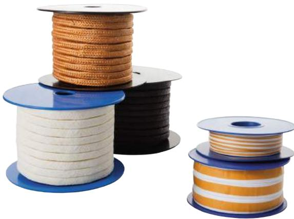
La empaquetadura trenzada se emplea para estanqueizar movimientos rotativos, alternativos o helicoidales. Su principio de funcionamiento o de estanqueidad se logra por la interferencia conseguida mediante un apriete exterior.
