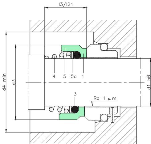
Tipo LS18: Longitud de montaje de la parte rotante  $l_3$ .
