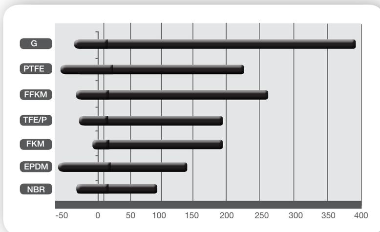
Siendo el NBR el material más económico y con menor rango de temperatura útil de trabajo, y el grafito el material más apto para trabajar a altas temperaturas. Dentro de los materiales elastómeros, el FFKM es el material con mayor resistencia a la temperatura, permite alcanzar los 320°C, en algunas mezclas especiales bajo demanda.
