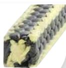
Tressée en diagonale, avec au centre des fibres de PTFE expansé, de graphite et de GFO® et dans les coins renforcés avec des fibres d'aramide.
